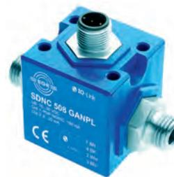
Die Strömungssensoren der Baureihe SDNC 500 zur Durchfluss- und Temperaturüberwachung bietet EGE-Elektronik auch in Varianten mit IO-Link-Funktion. Die smarte Lösung für kompakte Anlagen erlaubt die Konfiguration per IO-Link und die Nutzung von Prozessdaten auch für die Fernwartung. Sie erfassen Durchflussmengen flüssiger Medien im Bereich von 0,02 bis 8 l/min sowie Medientemperaturen von 0 bis +60 °C. Die Para-
