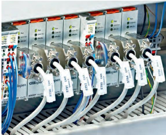
Die Kommunikation mit dem Prüfling entsprechend der Norm ISO 15765 ist über sieben CANopen-Masterklemmen EL6751 realisiert, was die Kosten im Vergleich zu bisherigen Lösungen um über 80 % reduziert hat.
