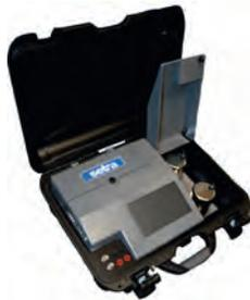
Ort eingesetzt werden. Kernstück dieses Kalibrators ist ein NASA-patentierter Druckgenerator mit 2 Druckkammern. Dieser erzeugt in kürzester Zeit ohne signifikante Überschwinger den gewünschten Differenzdruck. Im kleinsten angebotenen Bereich von ± 50 Pa wird eine Genauigkeit von 0,028
